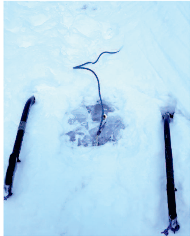
Abb. 3 Der Standplatz am Obstanser-Eisfall nach dem Absturz (bzw. beim Lokalausganschein der Alpinpolizei). Links der Platz bzw. die Eisqualität der ausgebrochenen Eisschraube, daneben die verbliebene zweite (rechte) Eisschraube mit den Resten der Reepschnur (im hohlen PA-Mantel befand sich nur ein kurzes Stück Aramid-Kern). Quelle: Unfallprotokoll von Alpinpolizist Klaus Hanser.
