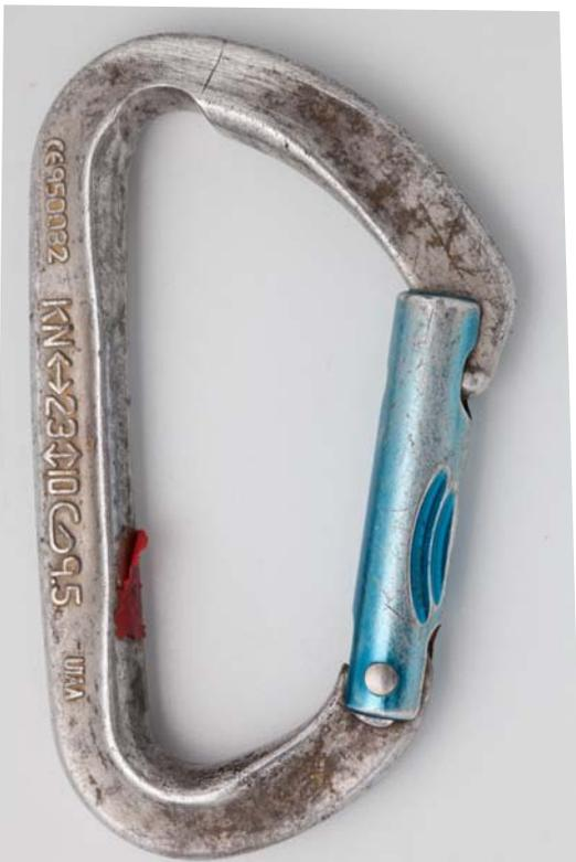
links: Diese Ausrüstungsgegenstände haben ihr Lebensalter erreicht und gehören entsorgt: eingeschliffenes Grigri, durchgescheuerter Abriebschutz, verschmutzter, scharf eingeschliffener Karabiner.
