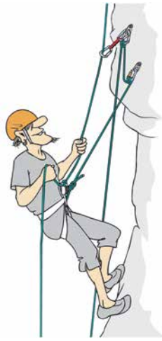
Abb. 2: Die Körpersicherung ist bequemer – aber nur bei hindernisfreiem Flugraum, mit langer Selbstsicherung und Dummyrunner oder Plus-Clip ohne Selbstgefährdung möglich.
