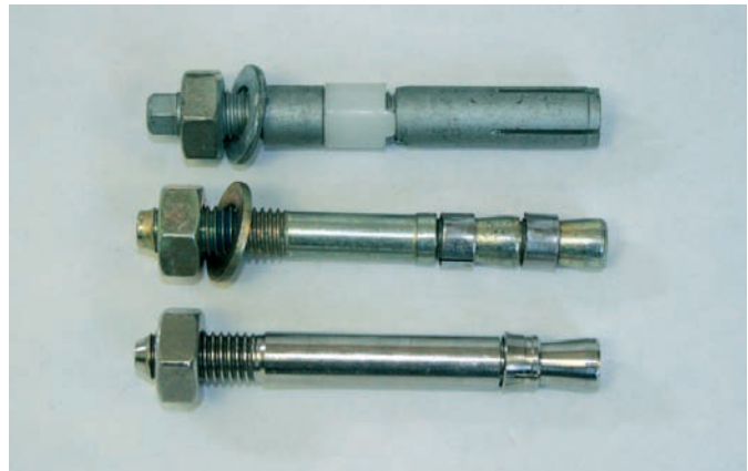
oben verzinkt, mitte gelbchromatiert, unten Edelstahl
