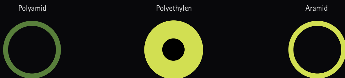
Abb. 4 Darstellung der Einwirktiefe der UV-Belastung auf den Werkstoff sowie die Festigkeitsreduktion/Einwirkzeit gelb = geringer Einfluss, dunkelgrün = höherer Einfluss (nach Dürbeck).
