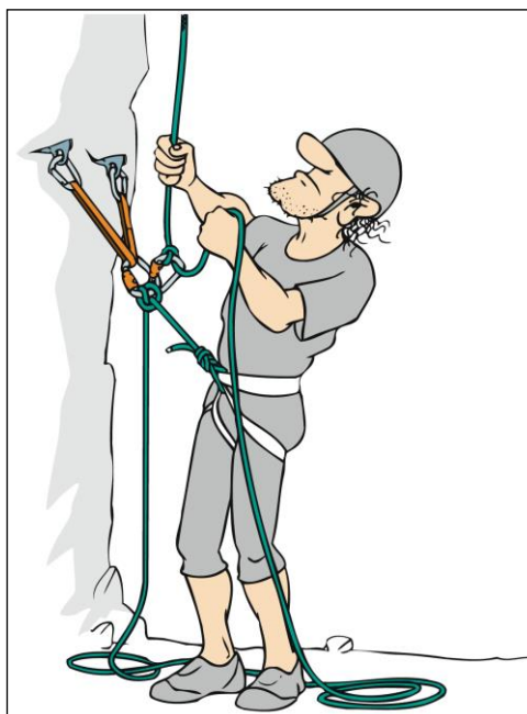
Afb. 6: zekering over het centrale punt met links een krachtendriehoek zonder opspannen en rechts met opspannen en dubbel afgebonden krachtendriehoek.
