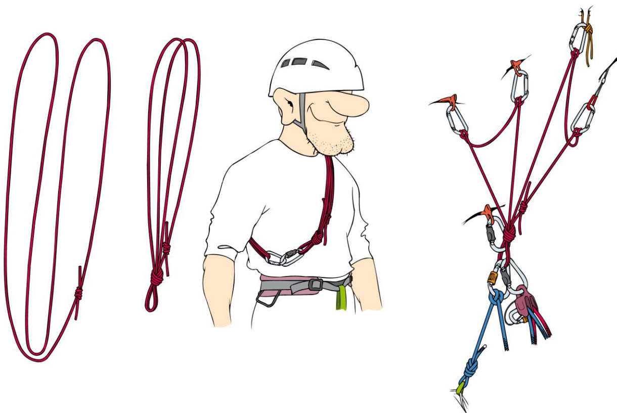
Afb. 24: opbouw en gebruik van de 'cordelette'.
